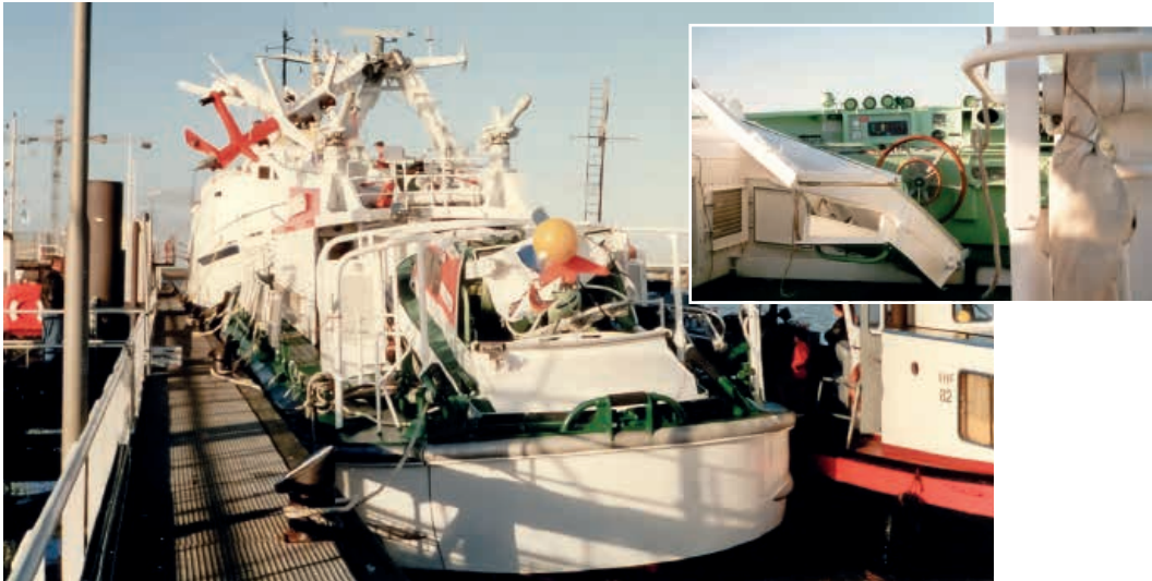
Die ALFRIED KRUPP mit abgeknicktem Mast in Eemshaven: Die Beschädigungen lassen die gewaltigen Kräfte des Wassers erahnen, die auf den Seenotrettungskreuzer eingewirkt haben.
