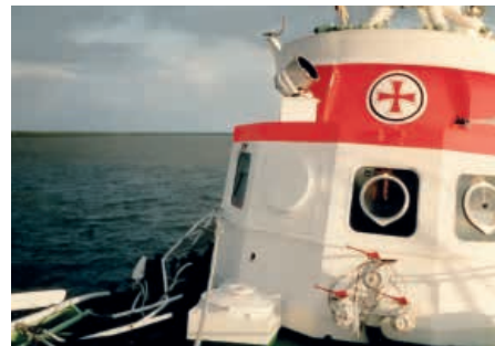
Selbst Teile wie die Reling, die der See wenig Angriffsfläche bieten, sind weggeknickt wie Streichhölzer.
